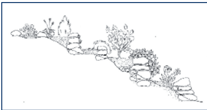
Figura 1. Corrección de una ladera mediante terrazas
