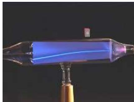
pequeña que la masa de los átomos de los gases empleados. De esta forma, se demostró que los rayos estaban formados por una corriente de partículas cargadas negativamente, de masa mucho más pequeña que la de los átomos, que llamó electrones.
