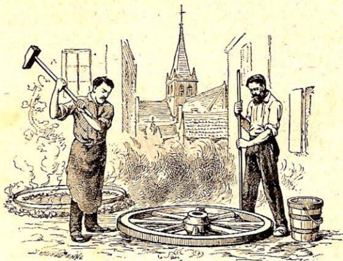
Fig. 39. — La llanta de hierro, *calentada*, se enfría y comprime las pinas de la rueda.
