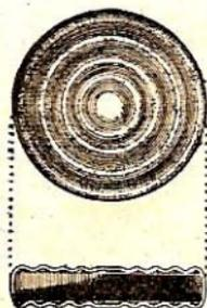
Fig. 22. — Caja vacía, de caras acanaladas, del barómetro metálico.
