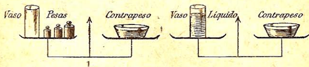
Fig. 37. — Peso de un líquido por doble pesada.
