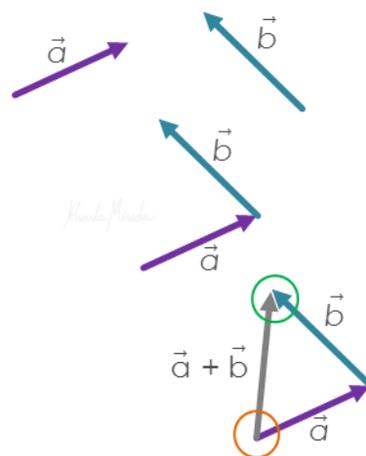
**Método del triángulo.** El vector suma es el que va del **origen**  $\vec{a}$ , al extremo de  $\vec{b}$ .
