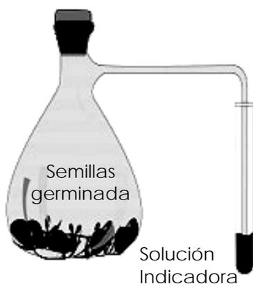
1. Dispense un volumen pequeño de solución diluida de rojo fenol en el tubo de ensayo (**5 ml**). Haga un marca en el menisco de la solución
