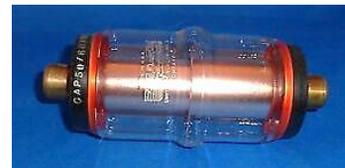
**Condensador variables.** Son aquellos cuya capacidad puede ser modificada intencionalmente de forma mecánica o electrónica, usándose aire o plástico como dieléctrico. Son utilizados en receptores de radio y televisión, entre otros, para igualar la impedancia en los sintonizadores de las antenas y fijar la frecuencia de resonancia para sintonizar la radio.
